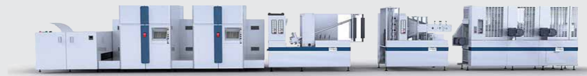
Sistema stampa digitale con piega Formerline per libri.
