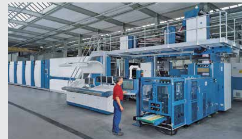
Rapida 145. Va a sostituire la precedente RA142 con un formato maggiorato (cm 106 x 145) e tantissime innovazioni che sono state riprese dalla campionessa dei tempi
